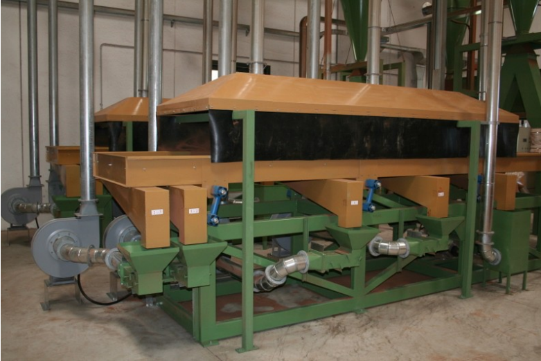
Vibrovaglio per selezione della granella di sughero
