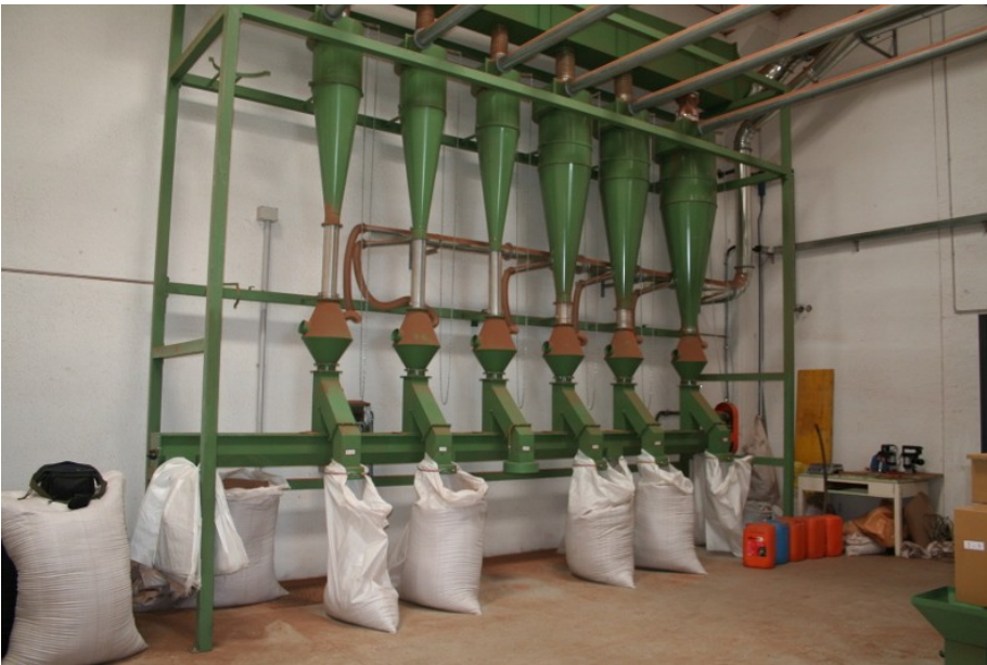
Gruppo cicloni per la raccolta in sacchi dopo la vagliatura della granella di sughero
